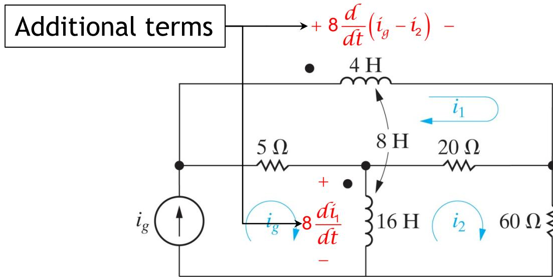
$$i_1 \text{ mesh} : 4 \frac{d i_1}{d t} + 8 \frac{d}{d t} (i_g - i_2) + 20 (i_1 - i_2) + 5 (i_1 - i_g) = 0$$
